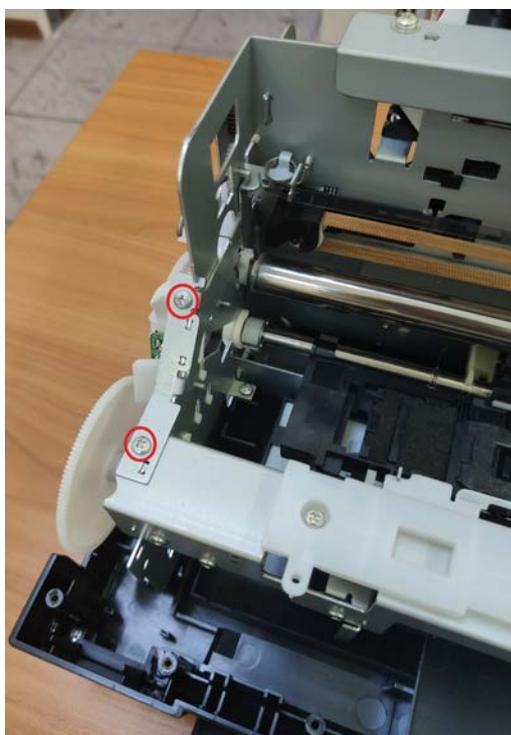
10. Вот мы и добрались до нужного элемента: снимаем металлическую планку, на которой проложен шлейф СМПЧ и нужные нам ролики. Откручиваем **4** винтика, поворачиваем на себя и получаем доступ к нужным роликам. На фото указал места крепления защелок. Так же фото одной из снятых планок с роликами. Снимаем все, остальные установлены и снимаются аналогично.
