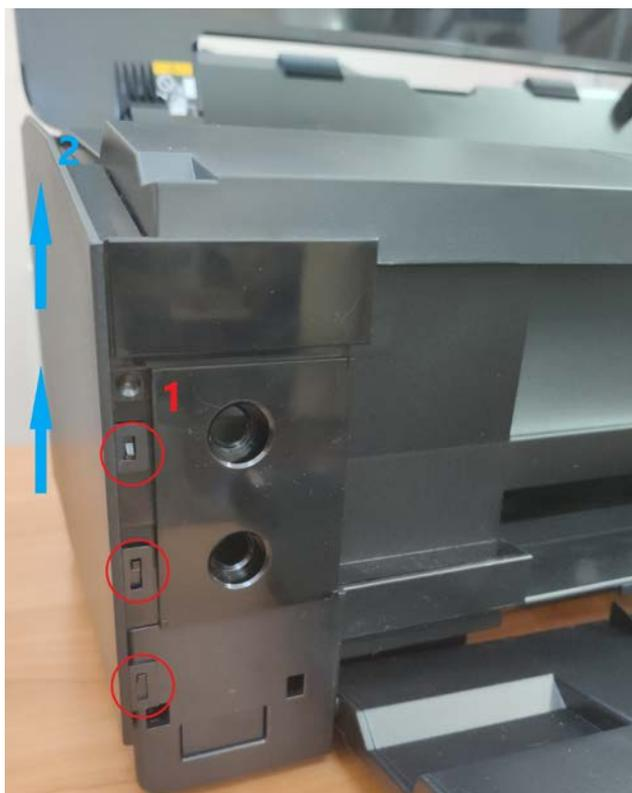
4. Снимаем с крючков СНПЧ, отодвигаем в сторону. Откручиваем 4 винтика, убираем заглушки, получаем доступ к выводу отработки чернил с ПГ (В дальнейшем рекомендую не ставить их обратно, оставить как на фото. Также рекомендую вывести отработку чернил в отдельный контейнер)
