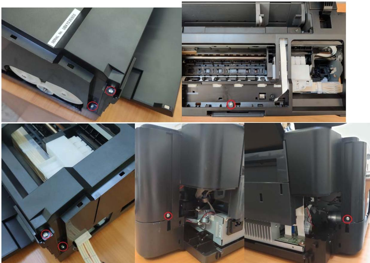
8. Снимаем переднюю пластиковую часть корпуса, откручиваем **4** винтика.
