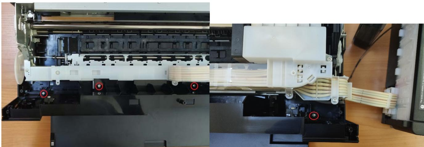
9. Далее откручиваем **2** винтика и снимаем перемычку – уголок (Возможно придется повозиться с его снятием и установкой обратно).
