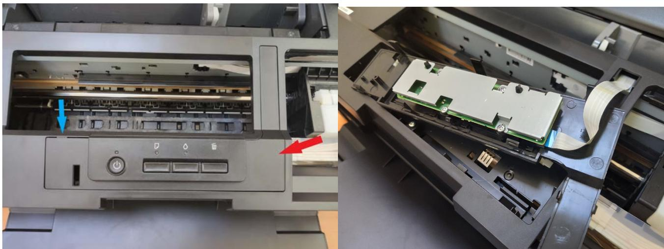
7. После того как отсоединили шлейф, нужно снять верхнюю часть корпуса, для этого откручиваем **7** винтиков и снимаем корпус.
